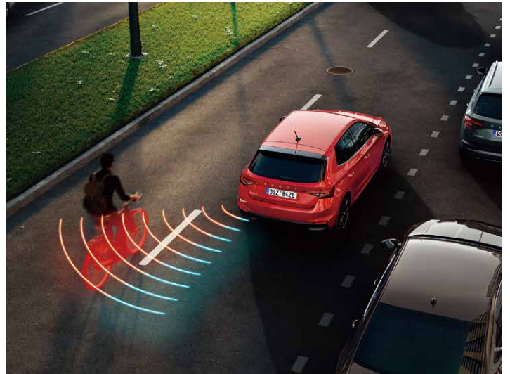
Side Assist 車側盲點警示系統運用雷達科技監控車輛兩側及後方區域，使變換車道更安全；特別是在高速公路上同時配備 Lane Assist 的情況，如果方向燈作動那側後方有車輛接近，系統會透過觸發方向盤震動並進行轉向干預來提醒駕駛，可監控最多 70 公尺的區域。
