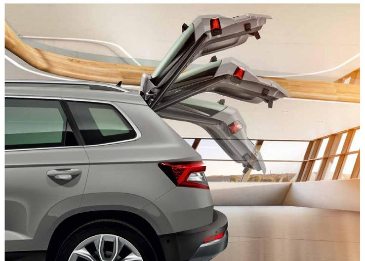
你知道嗎，KAROQ全車系標配的行李廂電動啟閉尾門，除了實用以外，還有開啟高度設定及防夾安全機制功能。不僅聰明，還更安全。
