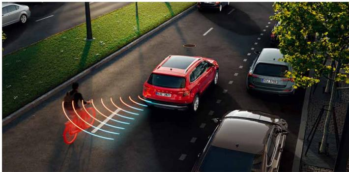
車側盲點警示系統可以透過感知器偵測最遠70公尺的車輛並給予駕駛警示，行駛於高速公路與雙線車道時格外受用。
