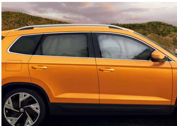
前後座頭部氣簾撞擊發生時，前後座頭部氣囊即可形成一面防護牆，以此減少乘客頭部傷害程度。
