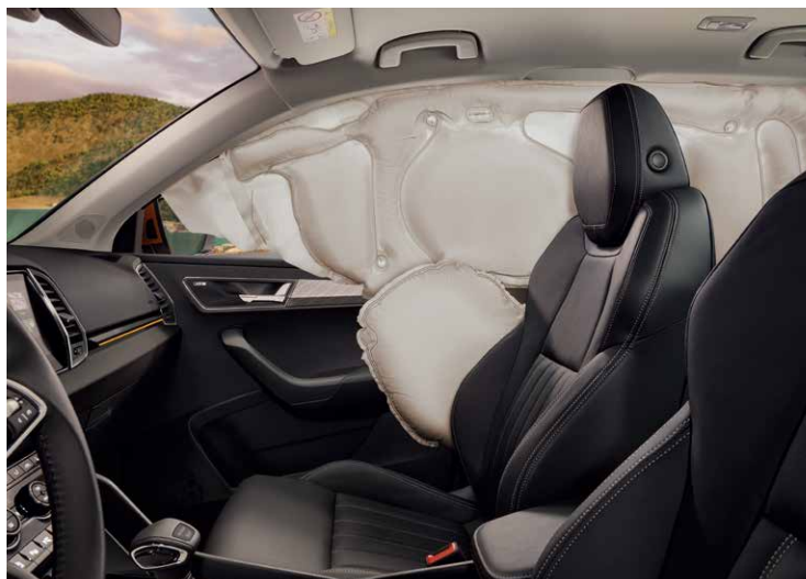
前/後座側邊氣囊發生側面碰撞時，前後座側面氣囊與頭部氣囊一起作動。能有效保護乘客胸部與骨盆。
