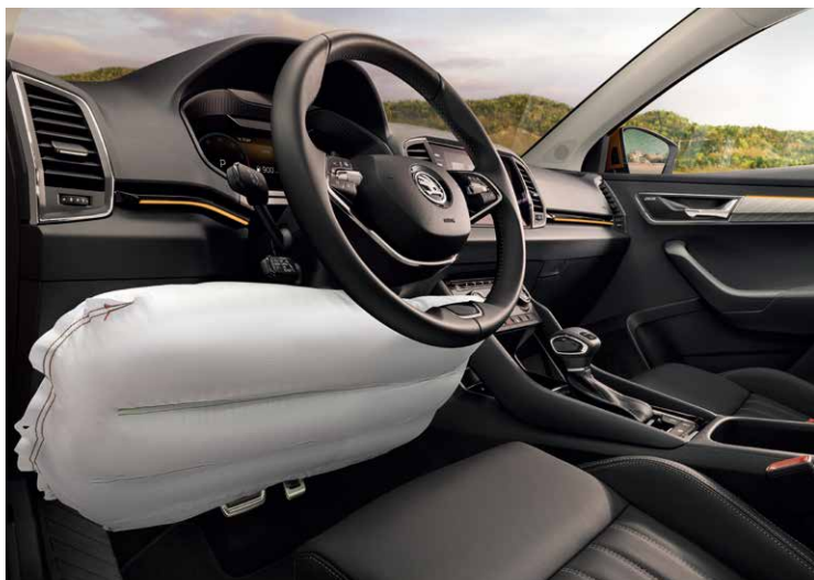
駕駛座膝部氣囊位於方向盤下方，發生撞擊事故時能保護駕駛者膝部。
