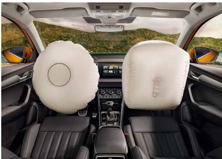
雙前座氣囊含乘客座氣囊啟閉功能駕駛者前方氣囊隱藏於方向盤中央，副駕駛前方氣囊則位於前方面板內部。
