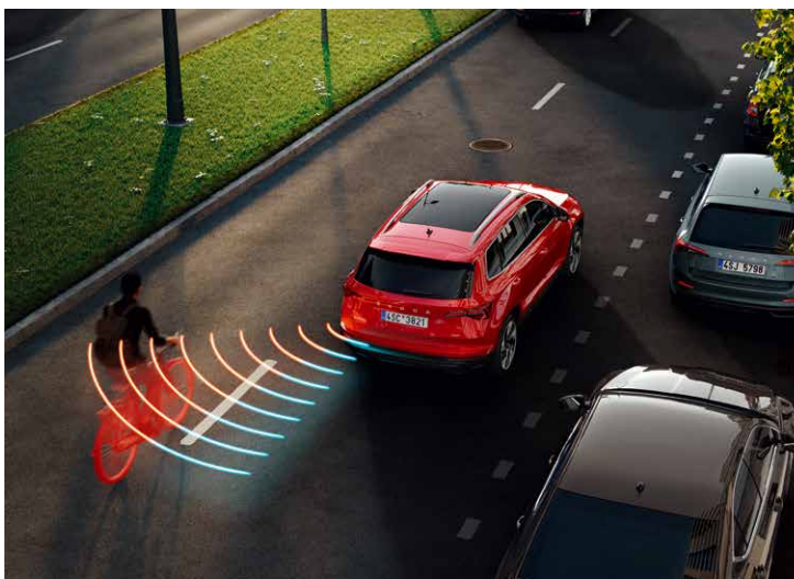
Side Assist 車側盲點警示系統運用雷達科技監控車輛兩側及後方區域，使變換車道更安全，可監控最多 70 公尺的區域。
